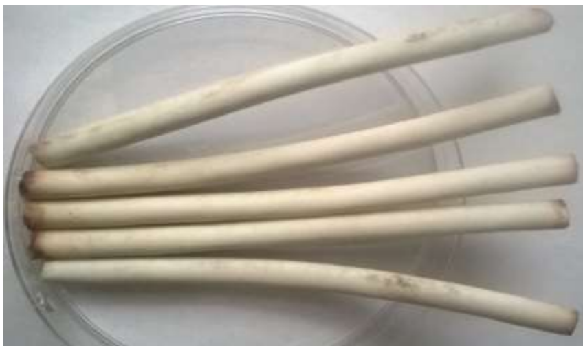
Рис.1. КАБЕЛЬ КВПГЭфнг(А)-5е- БГ 4х2х0,48 с оболочкой из безгалогенной полимерной композиции Mecoline S TP 1034F
