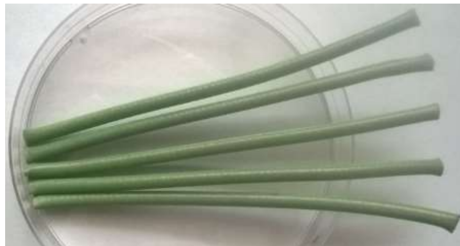
Рис.2. Кабель РК 50-2-42-С с оболочкой из фторопласта Ф-4МБ
